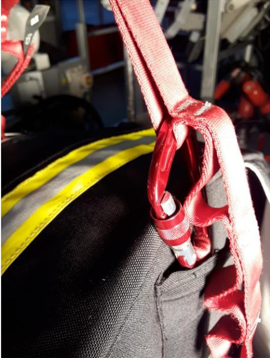
Um die Tasche in der richtigen Höhe zu positionieren ist die „Aufhängeschlaufe lang“ mit mehreren Schlaufen versehen.
