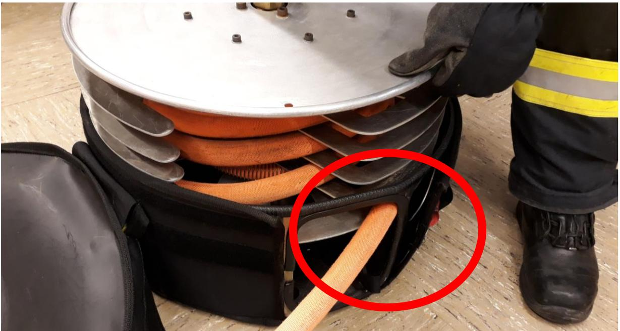
Entnehmen Sie die Kurzschlaufe, öffnen Sie die TACBAG und heben Sie die Haspel aus der Tasche. Dazu muss sich der Schlauch auf der untersten Ebene befinden. Ein Entnehmen aus der Tasche ist nicht möglich, wenn der Schlauch sich auf einer der oberen Lagen befindet.
