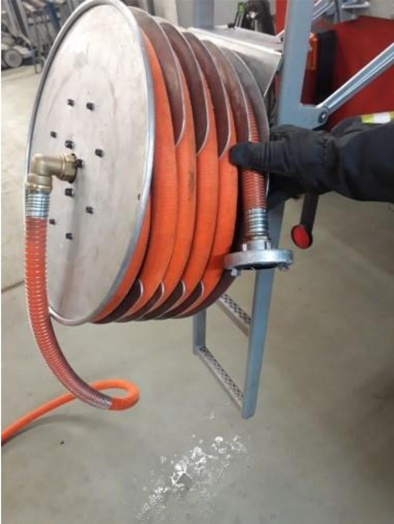
Zum Aufrollen des Schlauches kann die Halterung zum Einhängen am Dachaufstieg verwendet werden. Somit ist ein Aufrollen mit zwei Personen in kürzester Zeit möglich und die Haspel kann in der Tasche verstaut werden. Die Halterung ist als Zubehör erhältlich.
