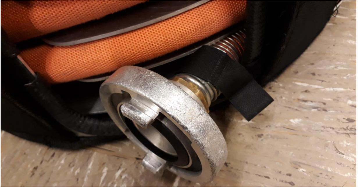
Befestigen Sie die Kupplung mit dem Befestigungsband, um ein selbstständiges Ausrollen des Schlauches beim Transport zu vermeiden.
