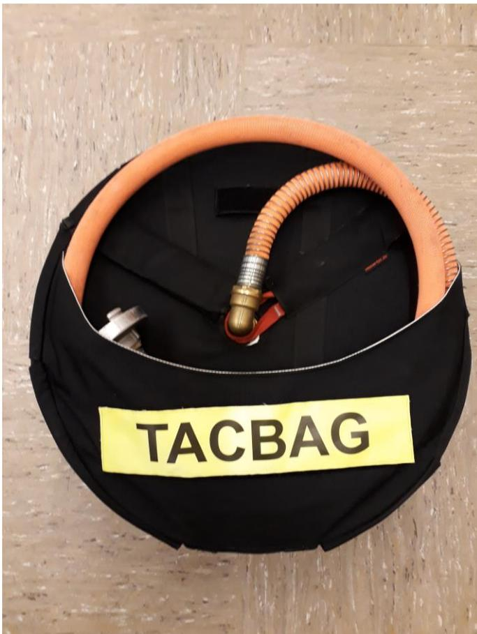
Legen Sie den Kurzschlauch in das dafür vorgesehene Fach und überprüfen Sie, ob die „Aufhängeschlaufe lang“ sich unbeschädigt in ihrer Einstecktasche befindet.
