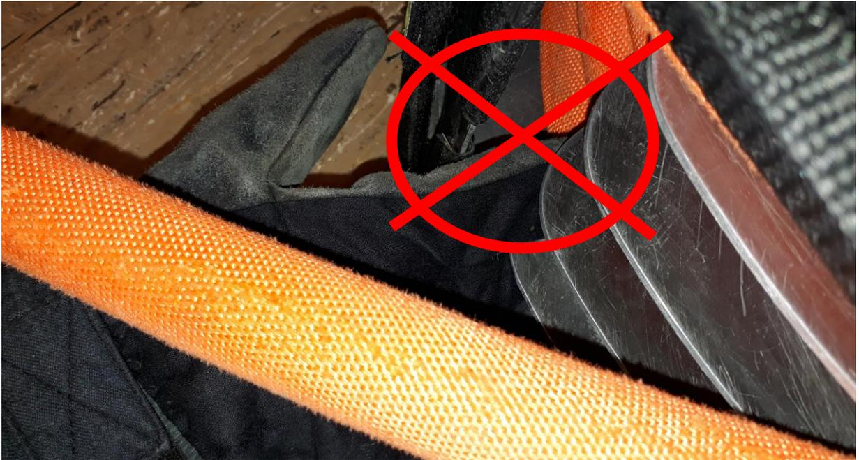
Greifen Sie nicht während des Abziehens vom Schlauch in die Schlauchaustrittsöffnung. Hierbei besteht erhebliche Verletzungsgefahr.
