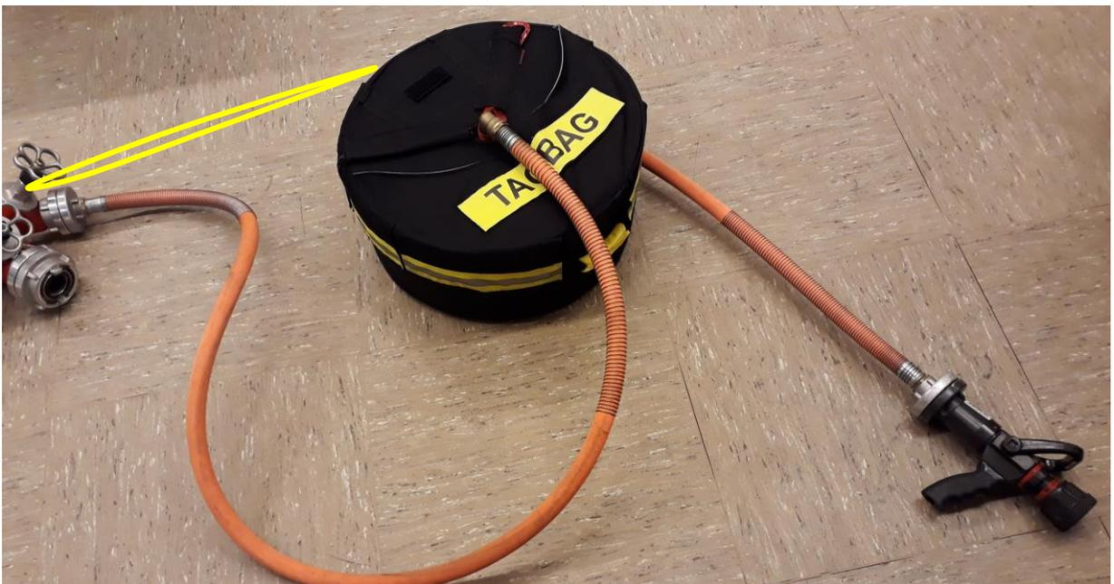
Alternativ kann die TACBAG als „mobiler Schnellangriff“ verwendet werden. Positionieren Sie die TACBAG am Eingang der Brandwohnung oder an der Zimmertür. Fixieren Sie anschließend die TACBAG mit der gelben Bandschlinge und ziehen Sie die TACBAG zur Zugangsöffnung, bis die Bandschlinge gespannt ist und nicht lose herunterhängt. Ziehen
