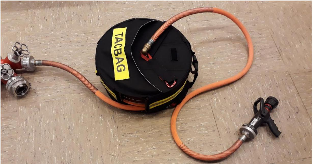
Variante TACBAG „mitgeführt“ in das Brandobjekt. Das Strahlrohr ist am Kurzschlauch angeschlossen.
