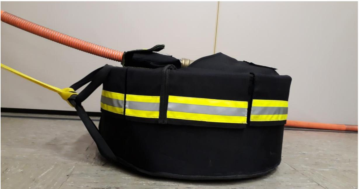
Ziehen Sie die TACBAG immer direkt am Griff oder an der gelben Bandschlinge nach. Achten Sie darauf, dass die Tasche immer parallel zum Boden geführt wird.
