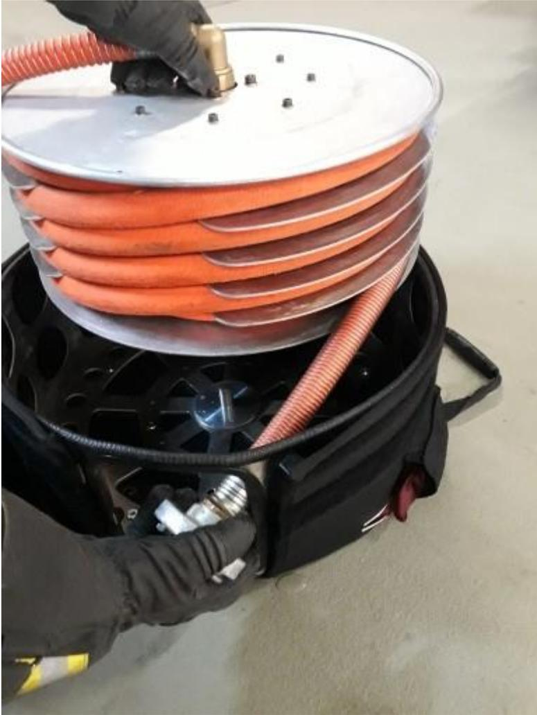
Nachdem der Schlauch auf die Haspel aufgerollt ist, kann diese in die Tasche eingesetzt werden. Achten Sie darauf, dass der Aufnahmedorn und die Aufnahmebuchse frei von Verschmutzungen sind. Heben Sie die Haspel in die Tasche und führen die Kupplung von innen durch die Schlauchaustrittsöffnung. Halten Sie den Schlauch dabei auf Zug, damit sich die Haspel leicht einsetzen lässt.
