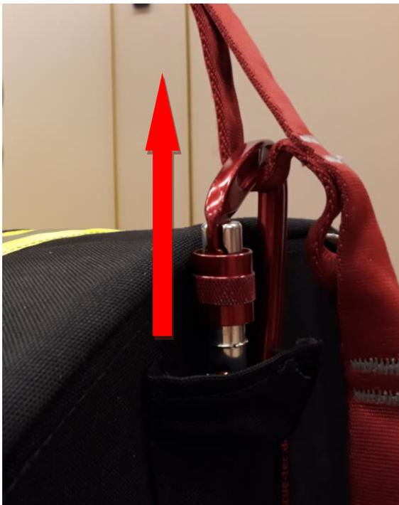
Die „Aufhängeschleife kurz“ immer nur in die Zugrichtung (Pfeil) belasten. Somit wird eine Beschädigung der Schlaufenführung ausgeschlossen.
