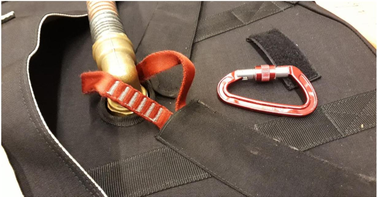
Nach dem Verschließen des Deckels muss die „Aufhängeschlaufe kurz“ angebracht und der Karabiner befestigt werden.
